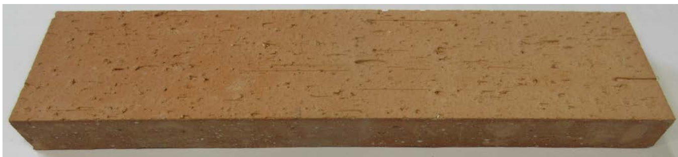
Figura 1. Riproduzione fotografica di un provino tal quale del prodotto "Listello 2x6x25 Rustico Pretrattato".
