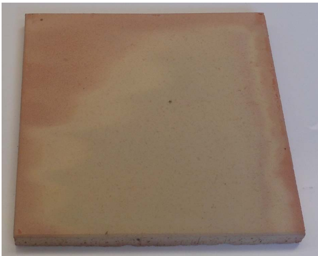
Figura 1. Riproduzione fotografica di un provino tal quale del prodotto “Cotto da pavimentazione linea “Prestige” spessore 2 cm”.
