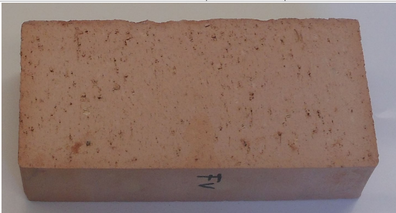
Figura 1. Riproduzione fotografica di un provino tal quale del prodotto "Mattone pieno".
