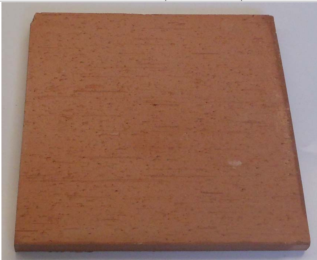
Figura 1. Riproduzione fotografica di un provino tal quale del prodotto “Cotto da pavimentazione linea “Rustica” spessore 2 cm”.
