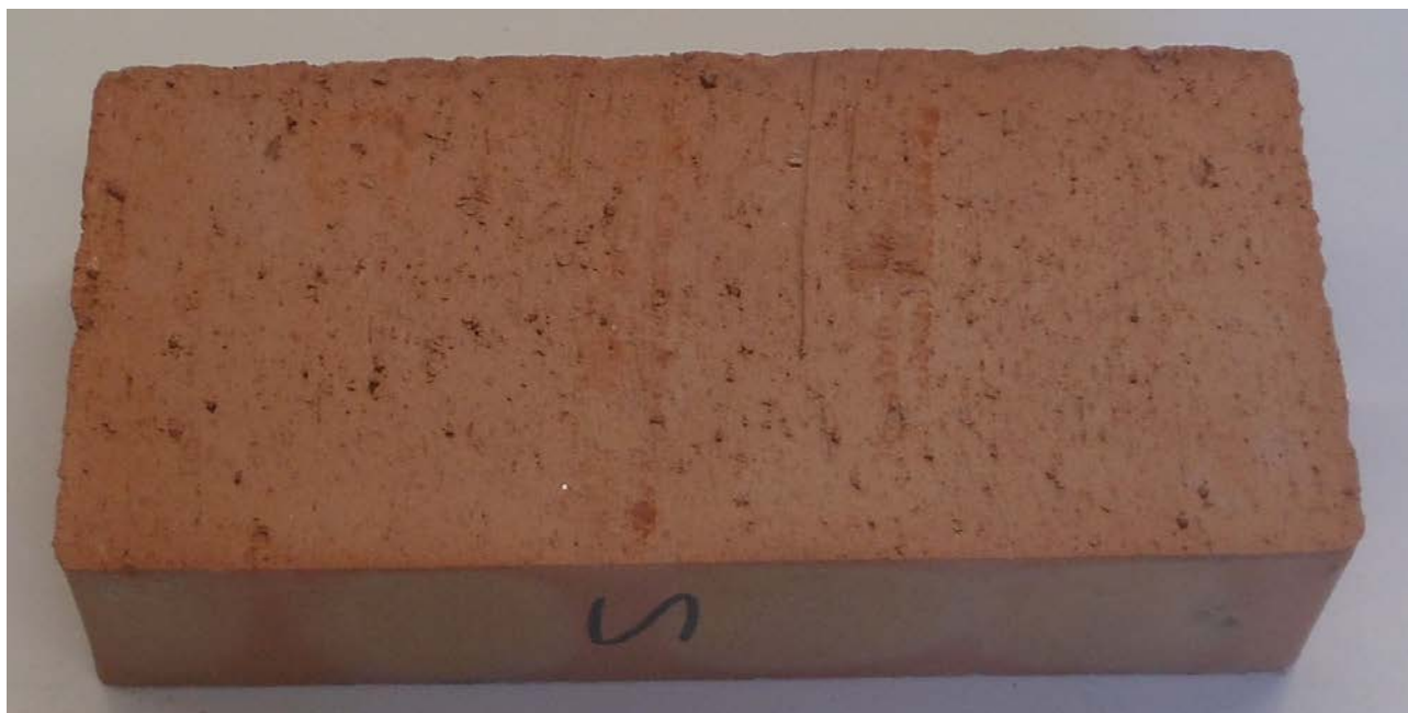
Figura 1. Riproduzione fotografica di un provino tal quale del prodotto “ Mattone pieno da muro ”.
