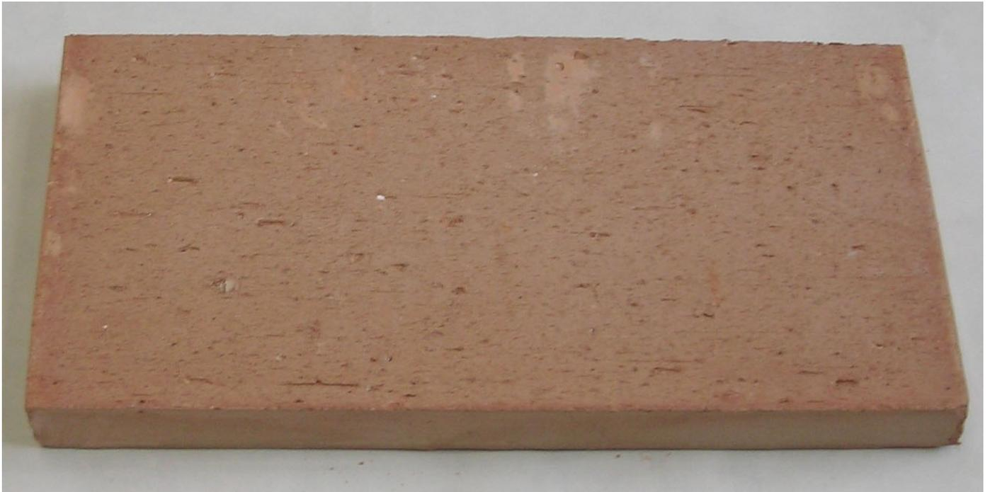
Figura 1. Riproduzione fotografica di un provino tal quale del prodotto “Cotto da Pavimentazione, spessore 2.5 cm”.
