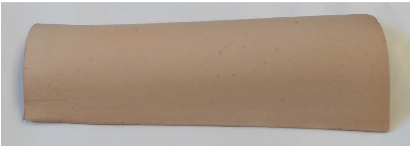
Figura 1. Riproduzione fotografica di un provino tal quale del prodotto "Coppo".
