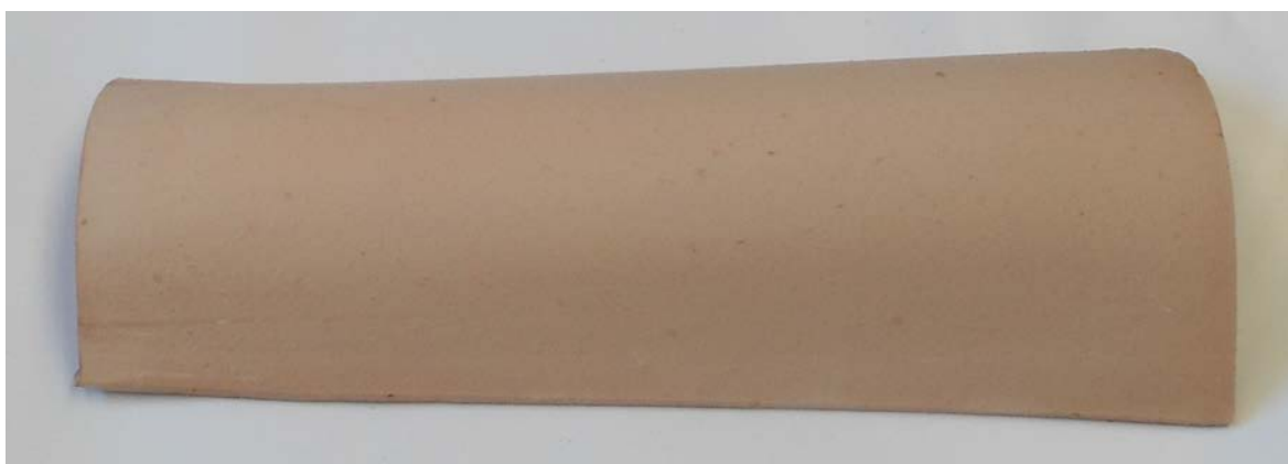
Figura 1. Riproduzione fotografica di un provino tal quale del prodotto "Coppo".
