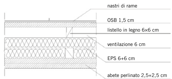
1b. Stratigrafie delle coperture a scala reale oggetto di monitoraggio.
