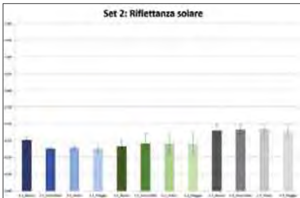
9. Misure di riflettanza secondo lo spettro di irradianza AM1GH dei campioni del set 2.
