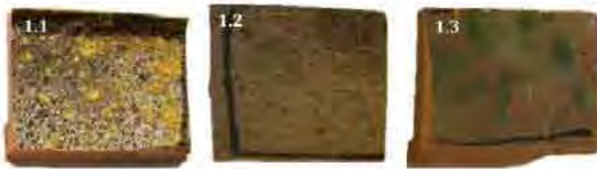
4. Foto dei campioni appartenenti al set 1: tegola in laterizio con ingobbio inorganico finishing ancien neuveau.
