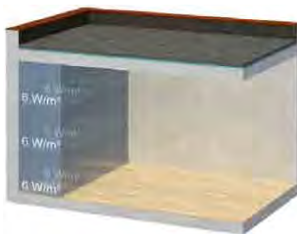
3. Potenza di climatizzazione interna per mantenere una temperatura indoor di 26°C.
