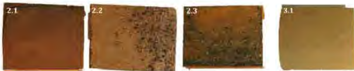
5. Foto dei campioni appartenenti al set 2 coppo in laterizio con ingobbio inorganico finishing ancien neuveau.
