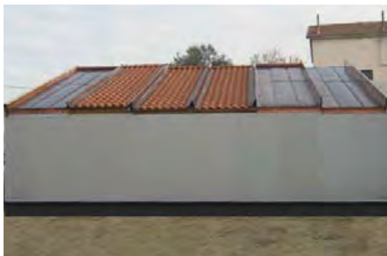
Figura 4 – L'edificio sperimentale e le coperture continue e discontinue oggetto di studio.
