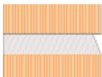
*I giunti a raso, invece, facilitano il deflusso dell'acqua a tutto vantaggio della durabilità della muratura.*
