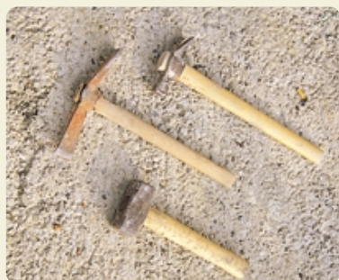
DUE TIPI DI MARTELLO E UNA MAZZETTA
