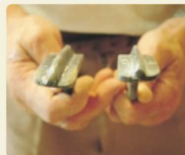
FERRI AD ALETTE PER GIUNTI INCAVATI STONDIATI
