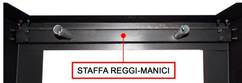
1. **INDIVIDUARE LA STAFFA REGGI-MANICI, OVVERO IL COMPONENTE PIEGATO AD "U" (VEDI FIGURA IN ALTO)** È uno dei componenti in lamiera piegato ad "U" che presenta due fori in cui bisogna inserire i due manici. Posizionare la staffa reggi-manici sul lato interno del quadrato. Inserire i bulloni  $\text{\O} 8 \times 40 \text{mm}$  cerchiati in rosso (vedi figura in basso a sinistra)
